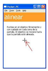
Luego procedemos a colocar el lápiz en la cruz, hasta que este se desplace, para luego repetir la operación hasta completar la alineación.
