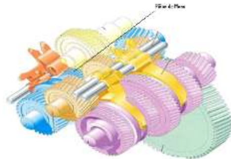
Estructura interna de la caja de cambios
