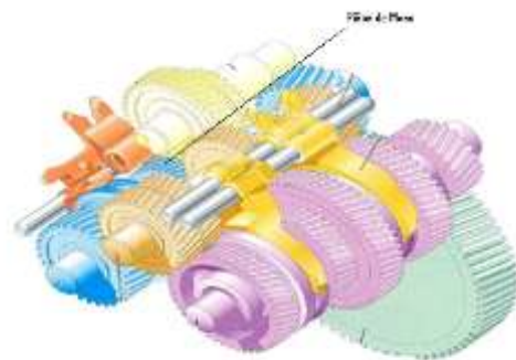
Estructura interna de la caja de cambios
